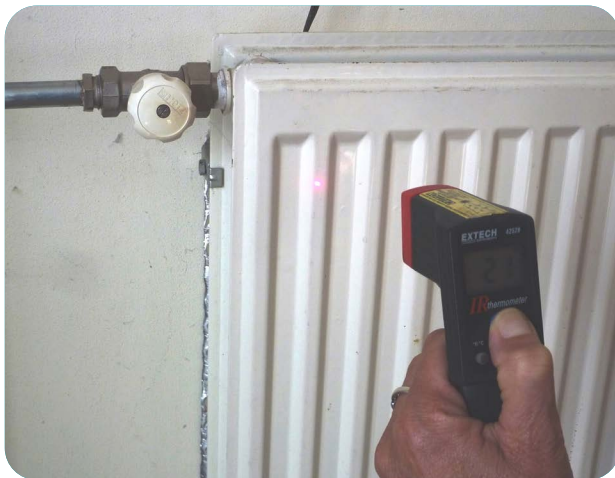
Meetmethode met laserthermometer
