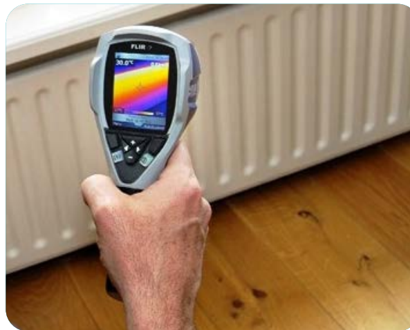
Meetmethode met warmtebeeldcamera
